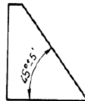
d Kotiranje tolerisanog ugla
