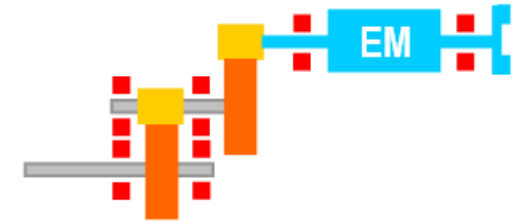
б) Редуктор са излазним зупчаником између лежајева, а другим на препусту
