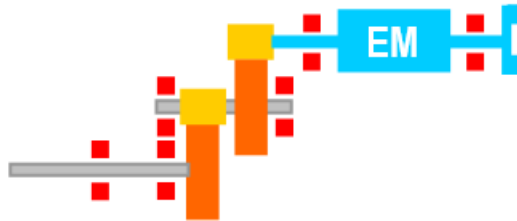
а) Редуктор са излазним зупчаником на препусту, а другим и трећим између лежајева
