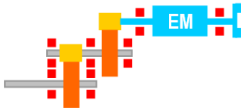
в) Редуктор са излазним зупчаником између лежајева и трећим зупчастим вратилом ослоњеним на три лежаја
