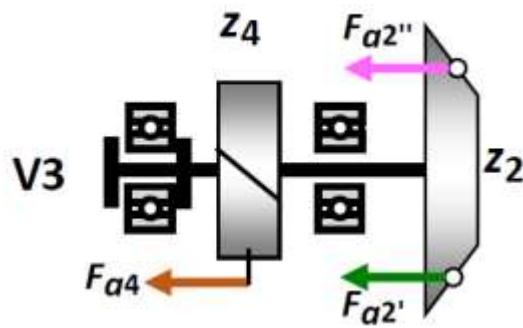
Pošto se obrtni moment  $T_2$  sa zupčanika  $z_2$  ne prenosi ceo na zupčanik  $z_3$ , najbolje je sile na zupčaniku  $z_2$  izračunati preko sila na malim zupčanicima  $z_1$  i  $z_3$ .
