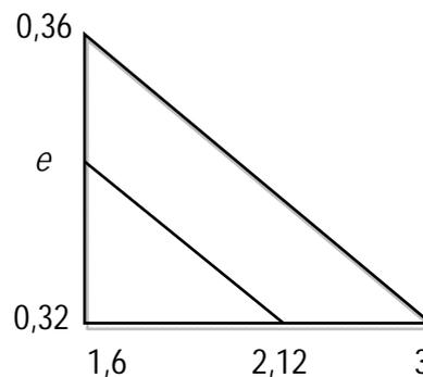
$$\frac{F_{aA}}{F_{rA}} = \frac{4078}{10440} = 0,391 > e = 0,335 \rightarrow \underline{X = 0,56}, \text{ a } Y \text{ se određuje interpolacijom.}$$
