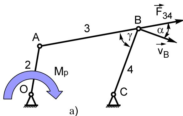
Kod zglobnog četvorougla, reakcija u zglobu  $B$  će pasti u pravac člana  $3$ . Brzina će biti upravna na izlazni član  $4$ . Tada se ugao pritiska  $\alpha$  može definisati i kao  $(90 - \gamma)$ , gde je  $\gamma$  ugao između članova  $3$  i  $4$ , poznat još i kao ugao prenosa (transmisioni ugao).
