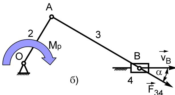
Kod klipnog mehanizma, ugao pritiska će biti ugao između spojnog člana  $3$  i pravca nepokretne vodice.
