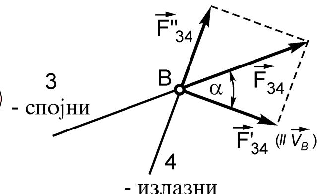
Ugao pritiska se menja tokom kretanja mehanizma. Mehanizam je **efikasniji ukoliko je ugao pritiska manji**. Za polužne mehanizme on prvenstveno zavisi od geometrijskih veličina - dužina članova, pa se on može postaviti i kao **dinamički uslov pri projektovanju** mehanizma.
