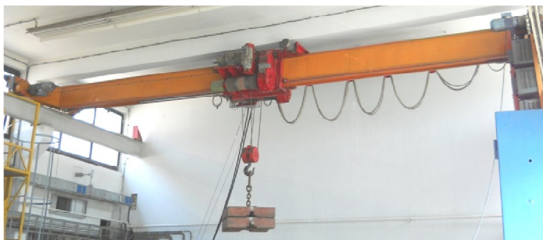
Sl. 1. Jednogreda mosna dizalica u laboratoriji MI D5
